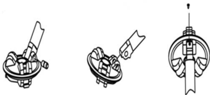
三辊闸转盘上杆步骤图
